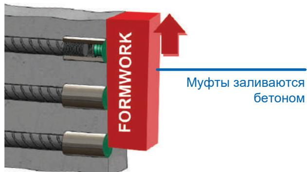
После заливки и отвердевания бетона арматурные выпуски ввинчиваются в муфты для начала армирования стен.
