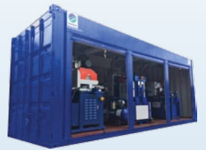
Bartec 钢筋加工设备装在集装箱中
