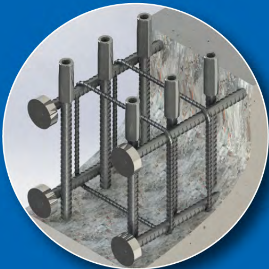
Anclaje de vigas
