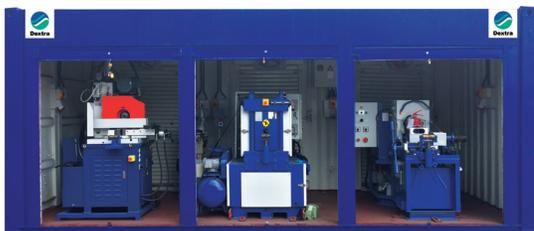
Las 3 máquinas necesarias para la preparación de barras de refuerzo del sistema Fortec están diseñadas por Dextra y se entregan en un conjunto (disponibles en contenedor acondicionado para uso en obra).
