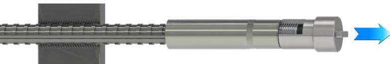
Der Zugversuch ist ein zerstörungsfreier Test. Die Zugbeanspruchung liegt unterhalb der nominalen Streckgrenze des Bewehrungsstabes, normalerweise bei 90% Re (70% für Durchmesser 40 und größer), so dass 100% der Stabenden bei einer Belastung geprüft werden, die höher als die tatsächliche Arbeitslast ist.
