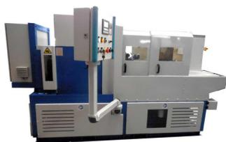
Rolltec-Maschine zur Aufbereitung des Stabendes
