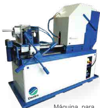
Máquina para preparação das roscas Rolltec
