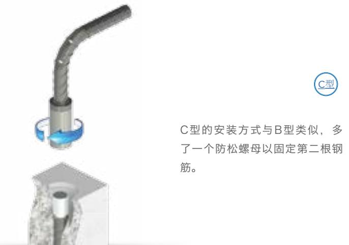
C型的安装方式与B型类似，多了一个防松螺母以固定第二根钢筋。
